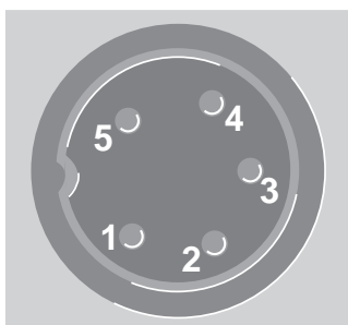
Fig. 6: Brochage de la prise pour des signaux de fonction (contacts au repos)
